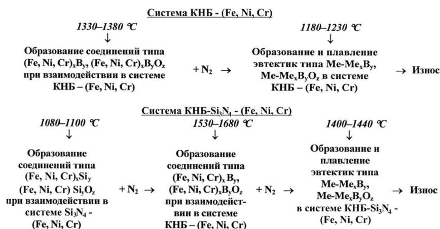
Рис. 13. Модельная схема влияния химического взаимодействия в зоне резания на износ инструментов, оснащенных композитами на основе cBN, при точении сплавов, содержащих Fe, Ni, Cr
