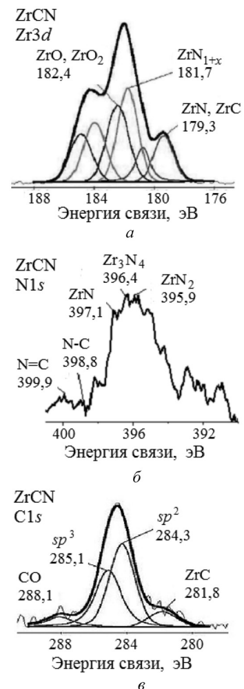
Рис. 3 Спектры РФЭС компонент покрытия и их деконволюция: Zr3d (а), N1s (б), C1s (в)
