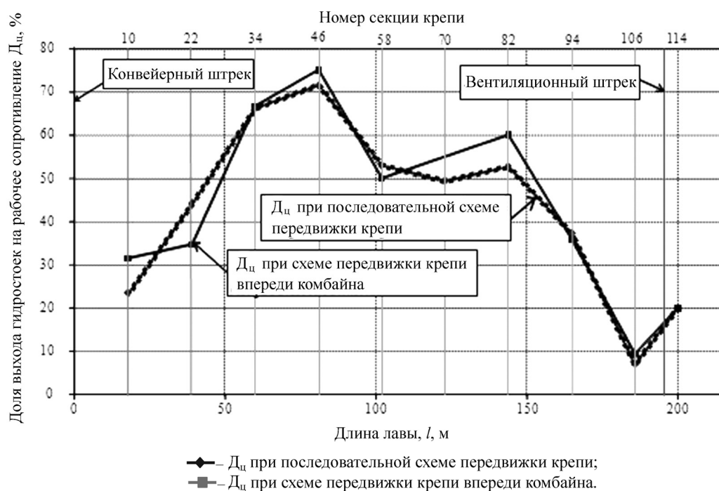
Рис. 3. Изменение доли циклов очистных работ ( D_{ц} ) со срабатыванием предохранительных клапанов по длине лавы № 102 при различных схемах передвижки крепи
