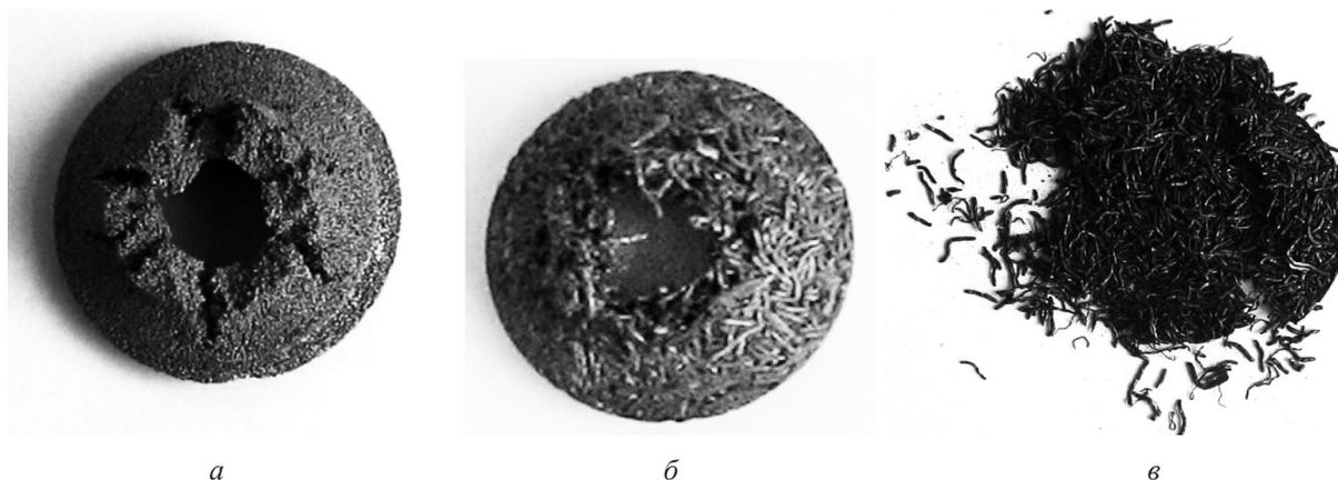
Рис. 3. Внешний вид образцов после механических испытаний: *a* – образец пористого порошкового материала из порошка оловянно-фосфористой бронзы, *б* – образец пористого волокнутого материала, спеченный при 1050 °С, *в* – образец пористого волокнутого материала, спеченный при 950 °С
