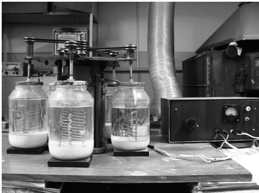
Рис. 3. Экспериментальная установка с механическим перемешиванием
