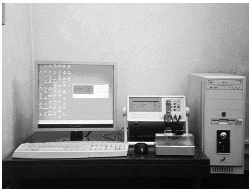
Рис. 1. Экспериментальная установка для контроля и диагностики электрических свойств композитов на основе ВПЭ в диапазоне частот электрического поля 50 Гц – 1 МГц
