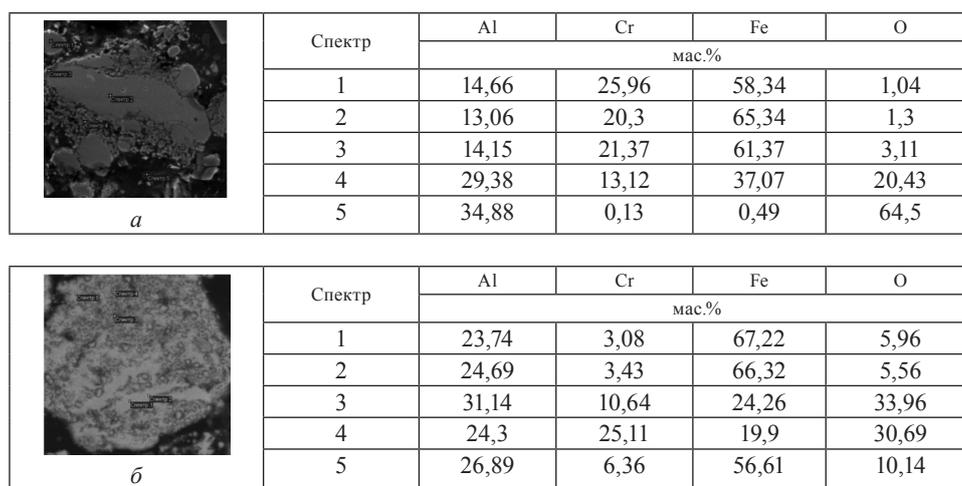
Рис. 2. Микроструктуры и таблицы результатов локального микрорентгеноспектрального анализа синтезированных порошков на основе моноалюминида железа, полученных из реакционных смесей ПХ-30 + Fe<sub>2</sub>O<sub>3</sub> + Al (а) и Fe<sub>2</sub>O<sub>3</sub> + Cr<sub>2</sub>O<sub>3</sub> + Al + Fe (б)
