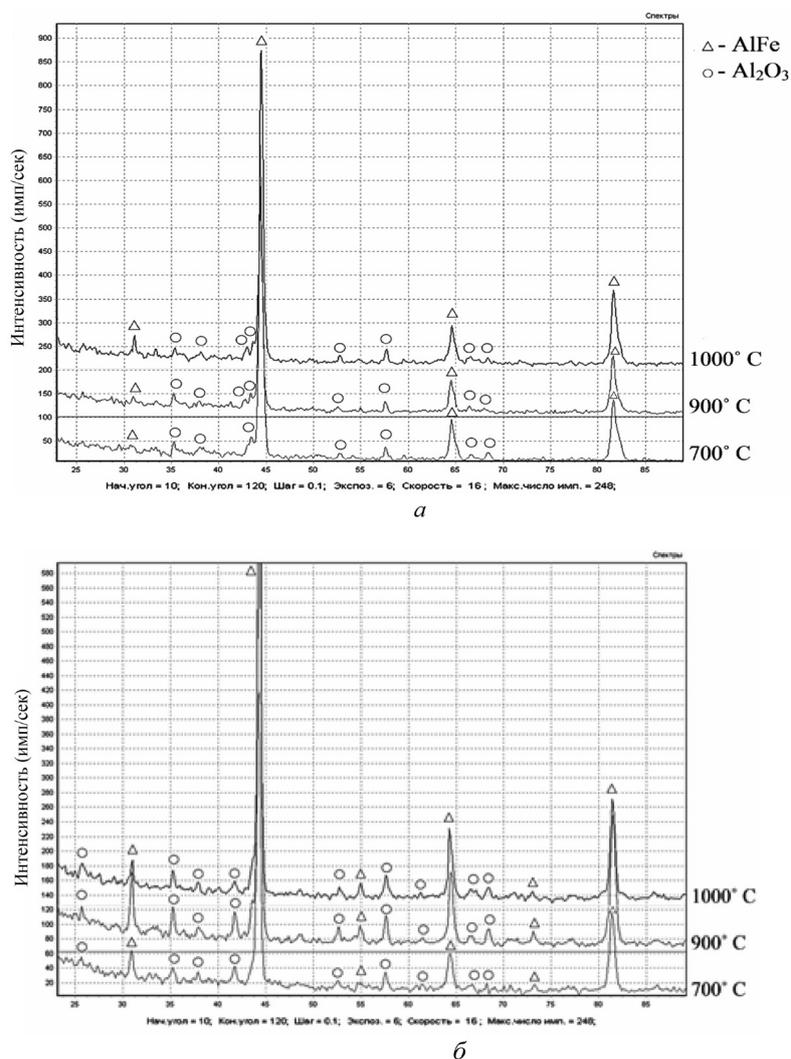
Рис. 4. Дифрактограммы композиционных порошков FeAl(Cr)/Al<sub>2</sub>O<sub>3</sub> после окисления из реакционной смеси, содержащей ПХ-30 (а), и из реакционной смеси, содержащей оксид хрома (б)
