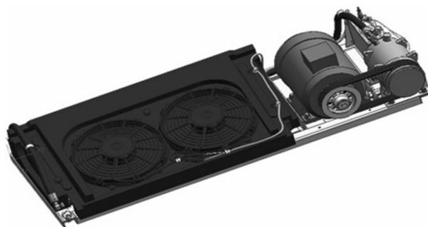
Рис. 1. Пример полной трехмерной твердотельной модели компрессорно-конденсаторного агрегата
