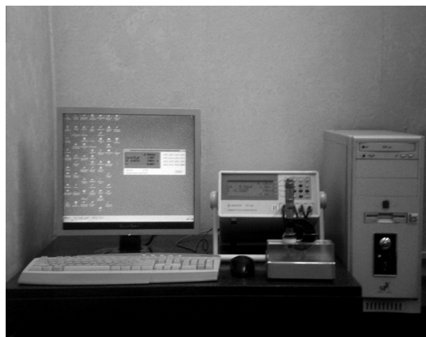
Рис. 3. Малогабаритная импедансная установка диагностического контроля диэлектрических показателей ЭМ электротехнического назначения
