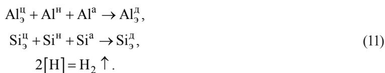
Натриевая эмульсия обладает относительно малым временем живучести. Она разрушается под действием адсорбированного водорода по эффекту Ребиндера.
