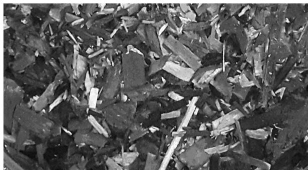
Рис. 2. Древесный уголь, полученный в опытах по пиролизу березовой щепы
