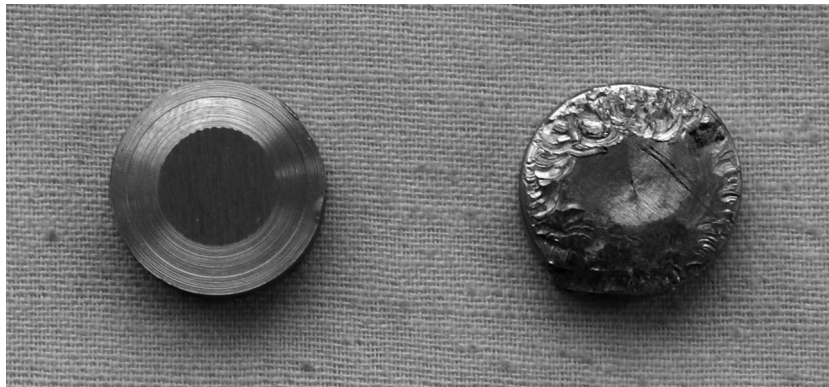
Рис. 2. Дисковидные образцы в исходном состоянии (а) и после ПП до вскрытия осевой полости (б)
