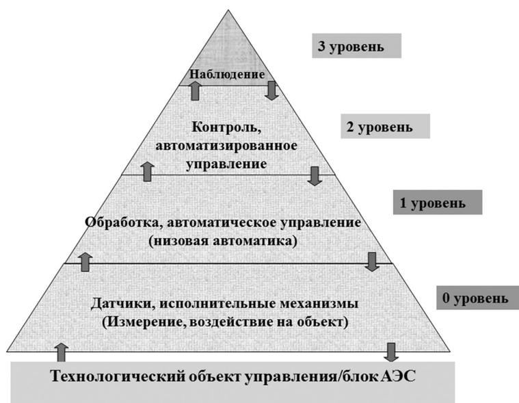
Рис. 1. Архитектура управляющей системы энергоблока АЭС
