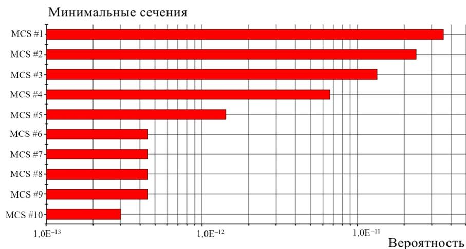
Рис. 3. Диаграмма вкладов доминирующих минимальных сечений для исходных событий LL1 при работе энергоблока на мощности
