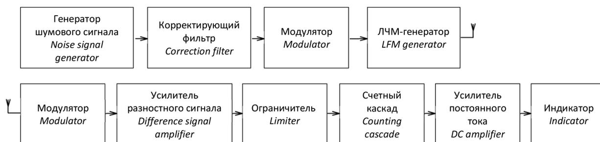
Рис. 6. Структура радиовысотомера с шумовым модулирующим сигналом
