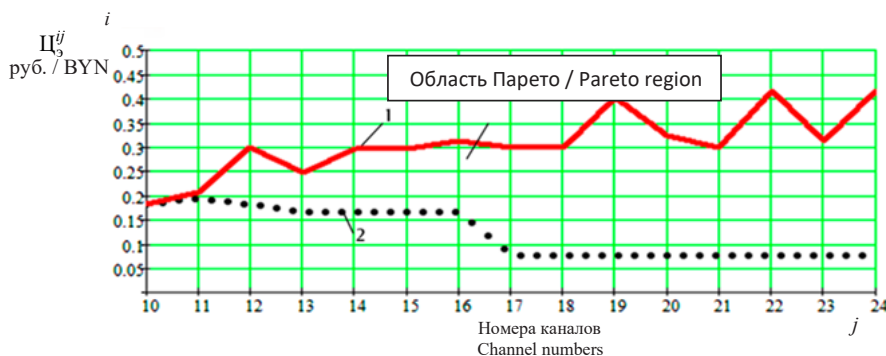
Рис. 2. График зависимости составляющей \Pi_{\tilde{p}}^{ij} (стоимость затраченной энергии на гидравлические потери давления в каналах СММ) при проходе рабочей жидкости между отверстиями входа i и выхода j (область Парето):
