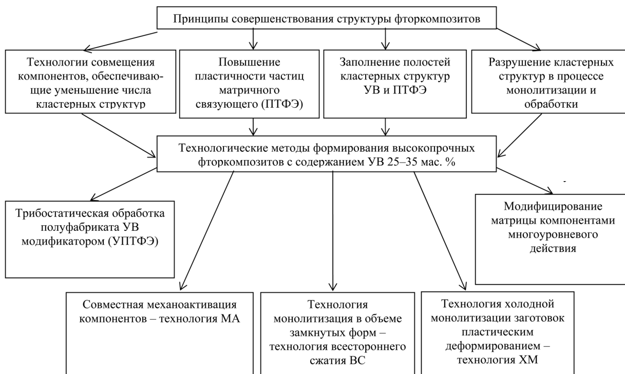
Рис. 4. Технологические методы получения высокопрочных износостойких фторкомпозитов с повышенным содержанием УВ
