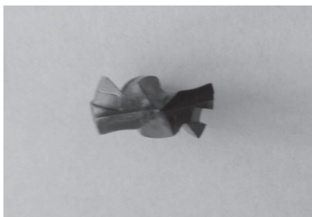
Рис. 2. Максимальный износ сверлильной головки серии DRILL RUSH
