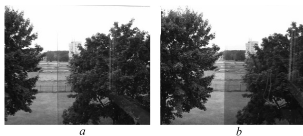
Рис.1. Прозрачность экранов в видимом диапазоне длин волн: 120(\text{In}_2\text{O}_3 + \text{SnO}_2)/\text{K8} (a) и 90\text{ZrO}_2/8\text{Ni}/90\text{ZrO}_2/22\text{Cu}/5\text{Ni}/35\text{ZrO}_2/\text{K8} (b)
