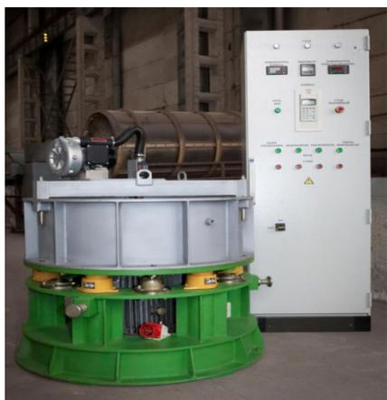
Рис. 1. Лабораторная установка для получения заготовок массой 30 кг
