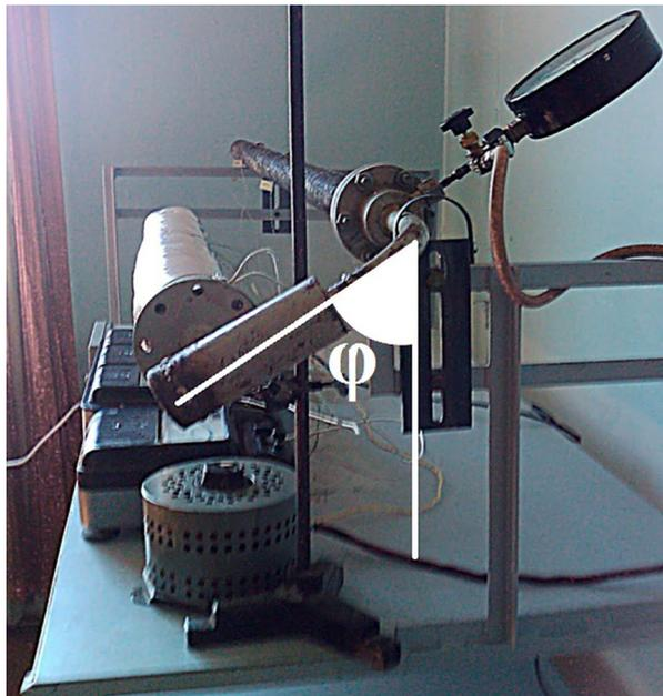
Рис. 5. Отклонение испарителя от вертикальной плоскости на угол  $\varphi$  (за изначальное принимается вертикальное положение термосифона)
