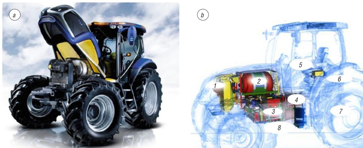
Рис. 4. Общий вид (а) и структурная схема (б) концептуальной модели трактора New Holland NH2: 1 – воздушный фильтр, 2 – резервуар для хранения водорода, 3 – топливные элементы, 4 – электродвигатели, 5 – питание вспомогательного оборудования, 6 – мощность для вала отбора мощности (ВОМ), 7 – сила тяги, 8 – внешнее электроснабжение
