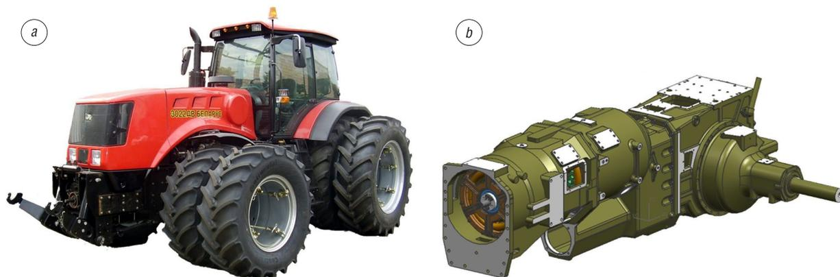
Рис. 9. Трактор «Беларус 3023» (а) с электромеханической трансмиссией (b)
