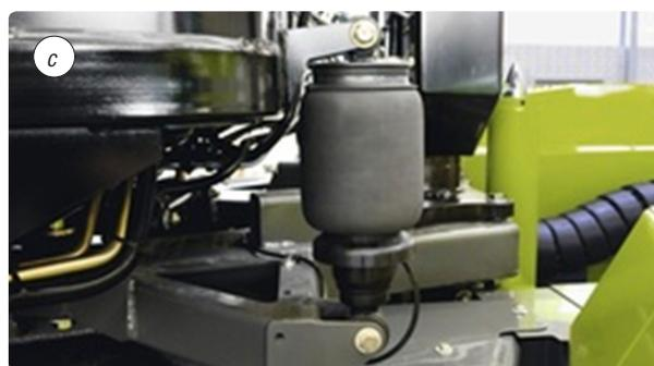
Рис. 6. Подвески кабин: *a* – пятистоечная кабина трактора Fendt 900 Vario, *b* – подвеска кабины Comfort Ride NEW HOLLAND, *c* – полуактивная подвеска кабины CLAAS
