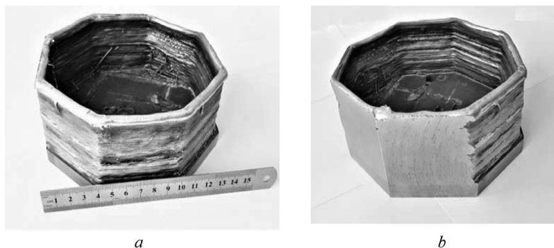
Рис. 8. Участок восьмигранной трубы, выращенный с применением электронного луча из проволоки LNM 304LSI на подложке из стали 12X18H10T до (а) и после (b) механической обработки Fig. 8. Octagonal-pipe section made using an electron beam from a LNM 304LSI wire on a 12Cr18Ni10Ti steel substrate before (a) and after (b) machining
