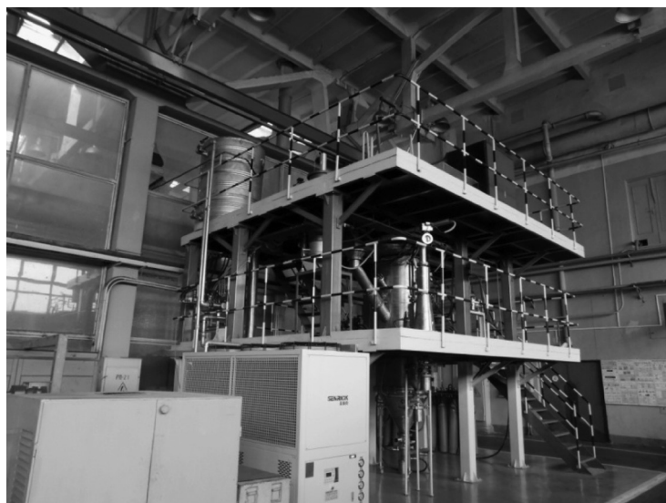
Рис. 2. Установка вакуумной индукционной плавки и распыления расплава инертным газом марки JT-QWH-25KG
