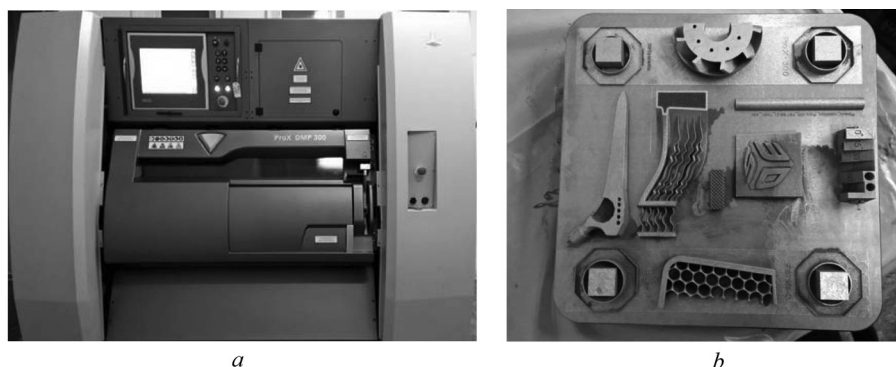
Рис. 6. Внешний вид 3D-принтера ProX DMP 300 (а), рабочая платформа принтера с образцами построенных деталей (b)
