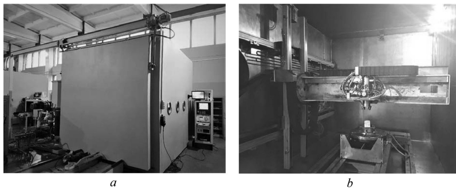
Рис. 6. Электронно-лучевое оборудование с габаритами камеры 3000 \times 3000 \times 4500 мм и мощностью электронного луча до 30 кВт (a); пушка, размещенная в портале (b)
