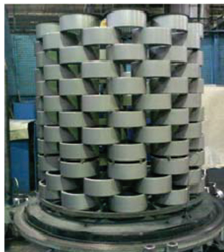
Рис. 5. Садка шестерен с внутренним зацеплением с общей азотируемой площадью 24 м 2
