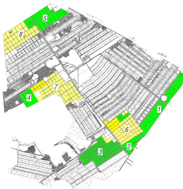
Рис. 1. План горных работ Третьего горизонта Первого рудника с цветовым выделением блоков камерной системы разработки, отработанных более 40 лет назад (зеленый цвет – без отработки 4-го сильвинитового слоя, желтый цвет – с отработкой 4-го сильвинитового слоя)
