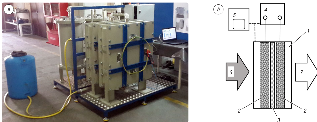
Рис. 1. Опреснительная установка (а), и схема прокачки соленой воды через ячейку (б): 1 – корпус опреснителя, 2 – пористый электрод, 3 – водонепроницаемый сепаратор, 4 – источник питания, 5 – управляющий компьютер, 6 – соленая вода, 7 – опресненная вода
