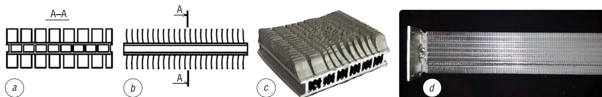
Рис. 2. Поперечное (a), продольное (b) сечение и внешний вид (c, d) теплообменной секции
