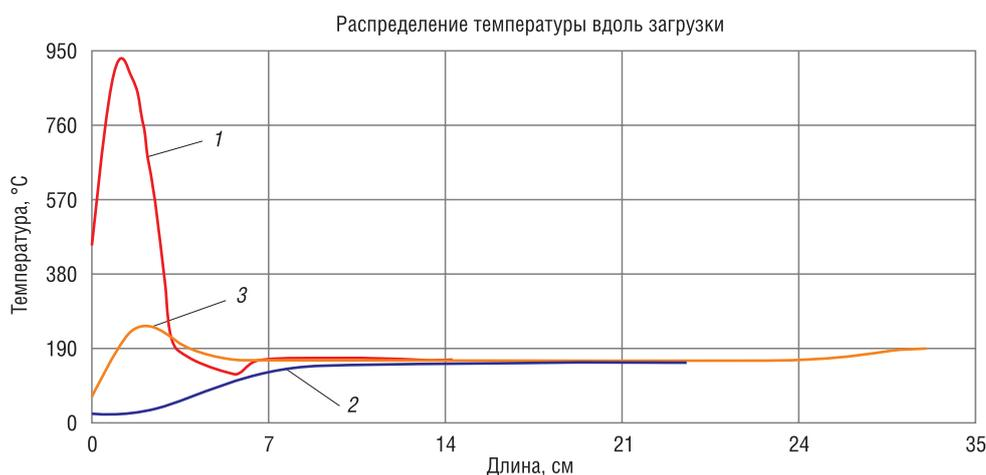
Рис. 3. Температурное поле штока в конечный момент времени при непрерывной закалке: 1 – температура на поверхности заготовки, 2 – в окрестности ее оси, 3 – средняя температура  $R/2$  (где  $R$  – относительный радиус цилиндра в диапазоне от центра (0) до поверхности (1))
