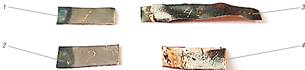
Рис. 1. Внешний вид медной шины после точечной контактной сварки: 1 – шина со слоем олова снизу; 2 – шина со слоем олова сверху; 3 – шина со слоем никеля сверху; 4 – сваренные луженая медная и никелевая шины
