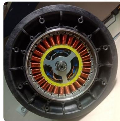
Рис. 1. Внешний вид исследуемой синхронной электрической машины с дробными зубцовыми обмотками
