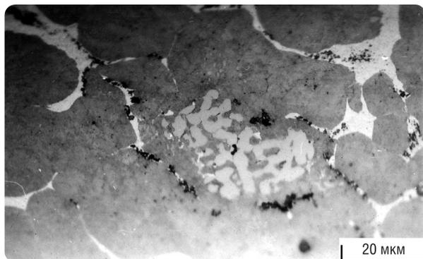
Рис. 3. Микроструктура штампованного при температуре 700 °С псевдосплава с инфильтрированным медью каркасом плотностью 75 % из стали ПК80Х3,
