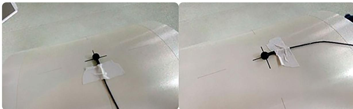
**Рис. 5. Способы крепления полупроводниковых диодов**
